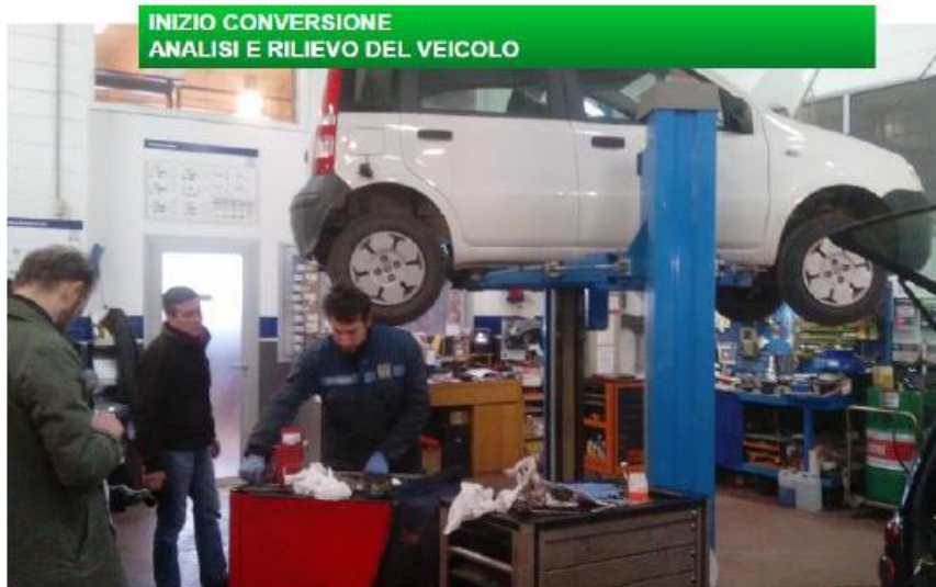
Veicolo sul ponte per rilievi sotto scocca.
